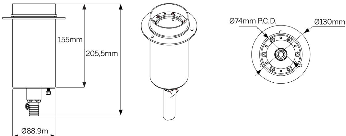
Pot d'encastrement – AM382S pour câble 1m Installation sur support béton avec alimentation latérale.
