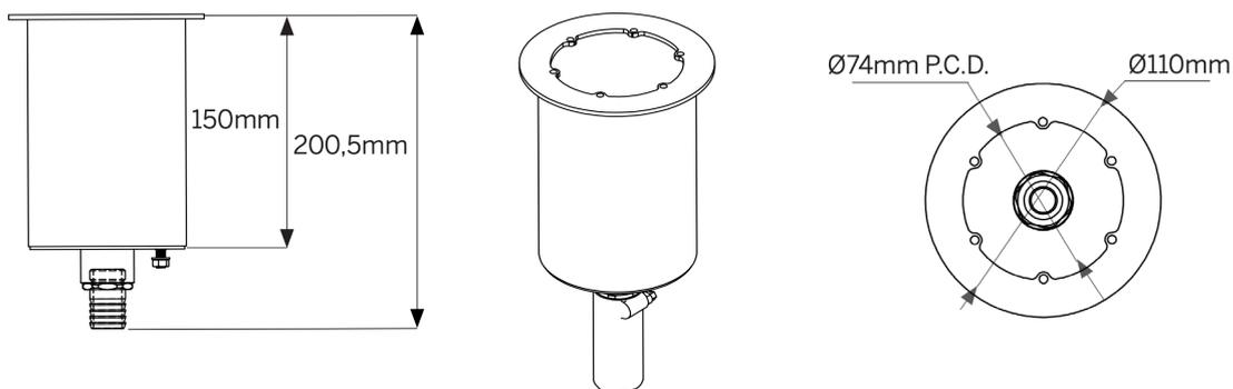
Pot d'encastrement – AM382LN pour câble 1m. Installation sur Liner
