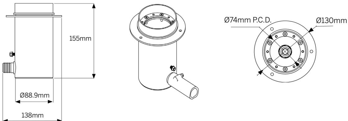
Pot d'encastrement – AM382SP pour câble 1m. Installation sur support acier.
