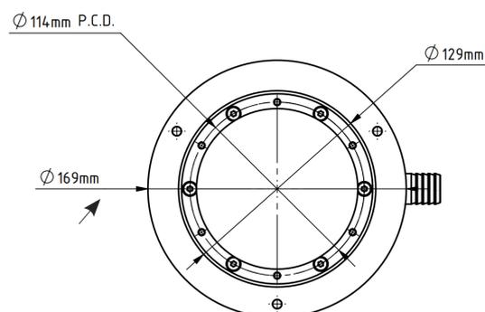
Installation encastrée AXMSP câble 2m fourni. Installation sur support acier.
